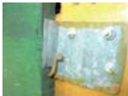
Pločevino L-profila, ki je pritrjena na sipalnik, zasidrmo za vijak na podnici.
